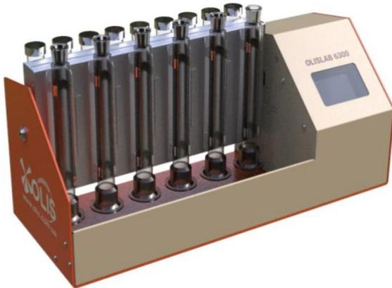
**Лабораторный шейкер OLISLAB 6300** предназначен для равномерного распределения твердой дисперсной фазы (муки или измельченного зерна) в жидкой дисперсионной среде (воде или растворах органических веществ) с целью образования гомогенной суспензии путем встряхивания по определенной программе.
