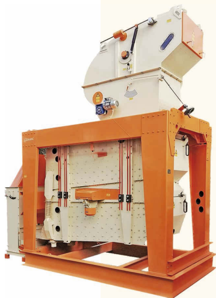
Rys. 1. Separator ziarna "HORYZONT-K" z separatorem powietrznym WSZ i z kolumną aspiracyjną KAO
